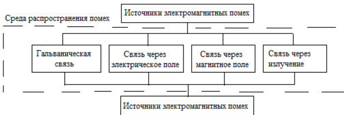
Рис. 6. Обобщенная схема возможного влияния электромагнитных помех на радиоэлектронные средства
