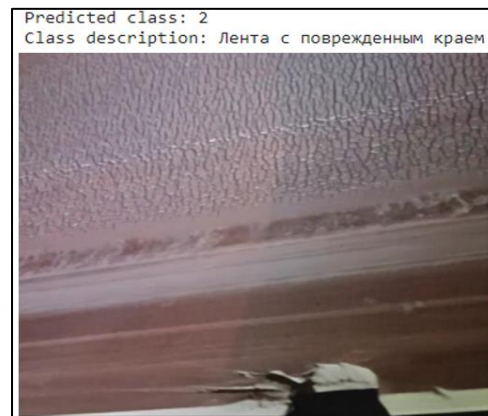
Рис. 2. Результат работы модели - «Лента с поврежденным краем» Fig. 2. Model output - "Belt with damaged edge"
